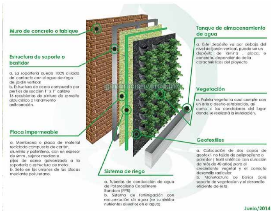
Figura 21: Proceso Constructivo de una Pared Verde
