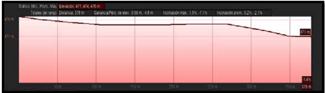
Figura 51: Perfil Longitudinal del Tramo 2-3
