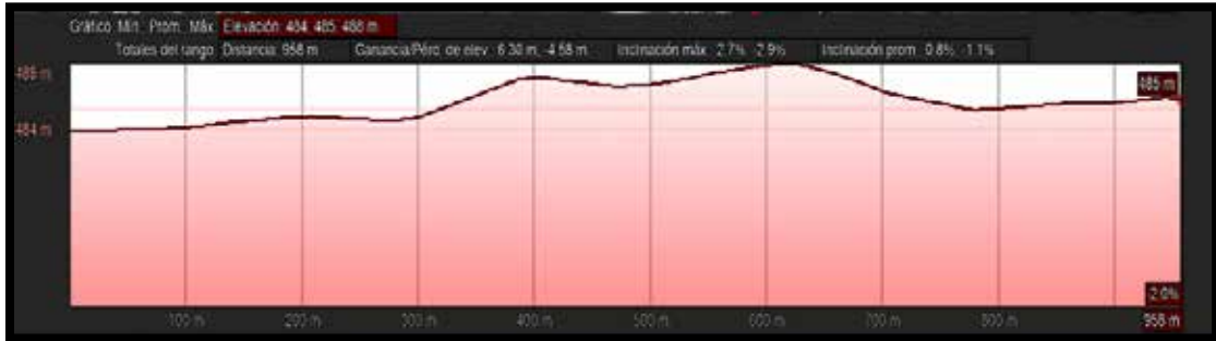
Figura 54: Perfil Longitudinal del Tramo A-B
