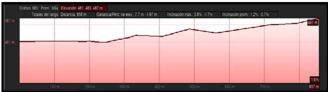
Figura 53: Perfil Longitudinal del Tramo 4-5
