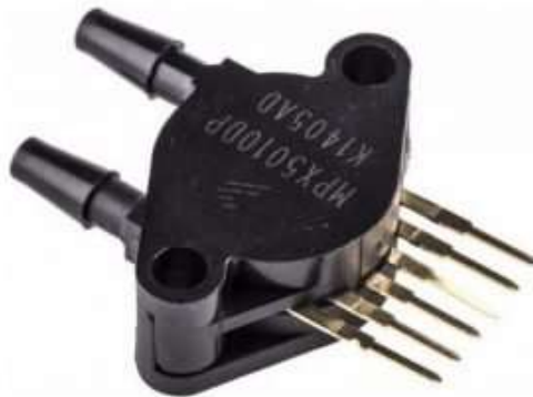
Figura 23: Sensor de Presión Diferencial MPX5010DP Fuente: Castaño S. (2019)
