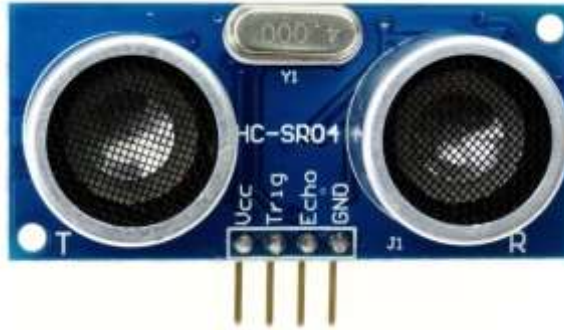
Figura 22: Sensor ultrasónico HC-SR04 Fuente: Castaño S. (2019)
