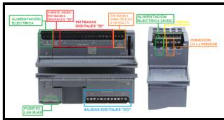
Figura 20: Entradas analógicas de un PLC Siemens S7-1200
