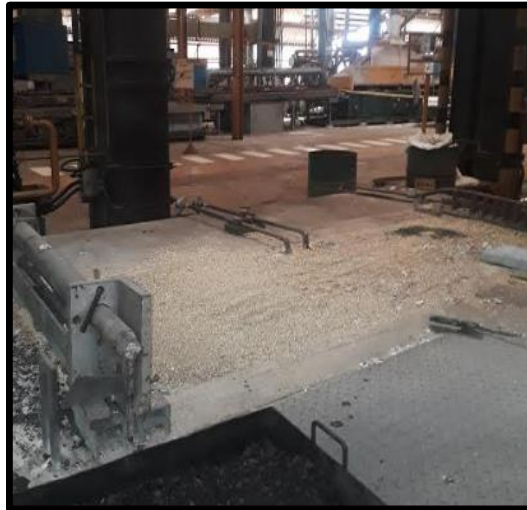
Figura 4. Tina de zinc de la línea de galvanizado tres (2) de la empresa Vicson, S. A. Fuente: Departamento de Producción Vicson, S. A. (2018)
