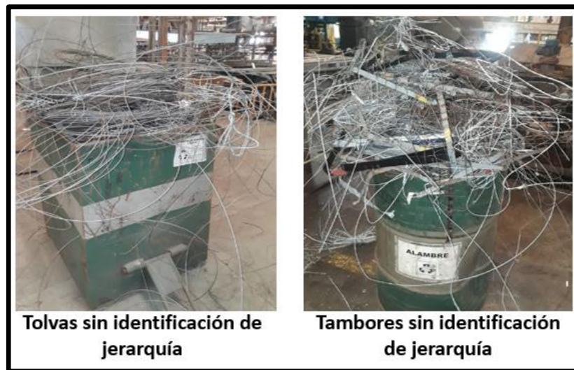
Figura 10. Segregación incorrecta en tolvas y tambores sin identificación de jerarquía Fuente: Hernández J (2018)
