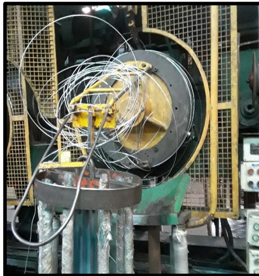
Figura 9. Enredo por falla en el dosificador en el banco enrollador de la línea de galvanizado dos.
