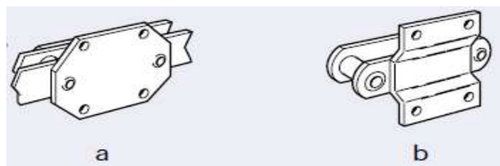
Figura 11. Accesorios tipo G. a) Accesorio tipo G de placa externa, b) Accesorio tipo G soldado o remachado a la placa de unión.
