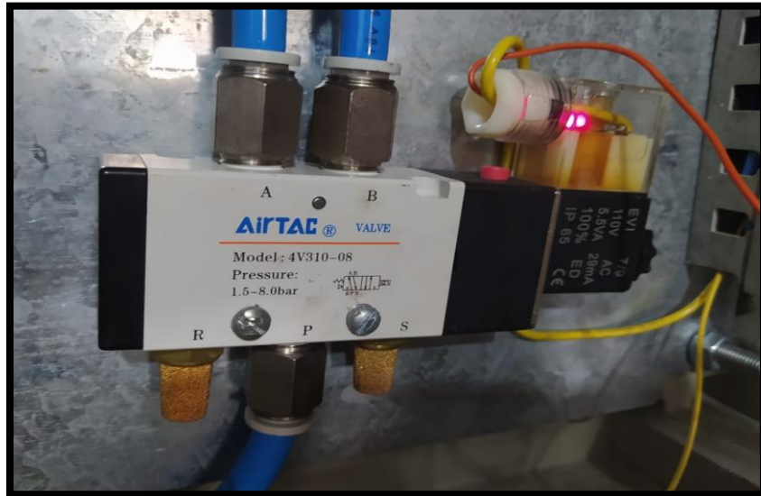
Figura 17. Válvula solenoide Fuente: Barrios y Bolívar (2023)
