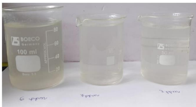
Imagen 2. Resultados de pruebas con dosis de 6 ppm, 7 ppm y 8 ppm de polímero
