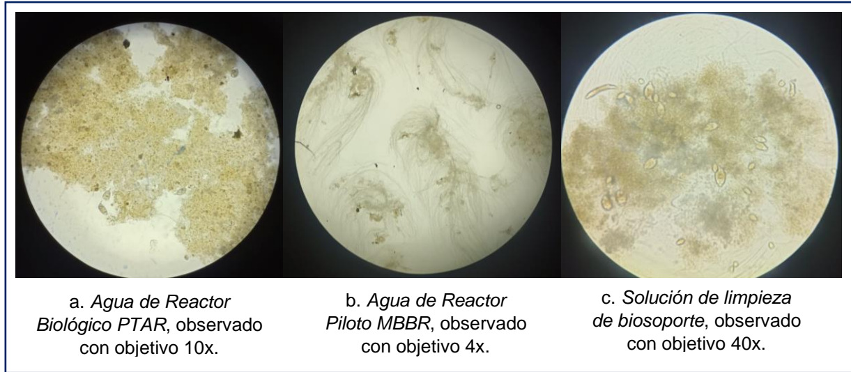
Figura 51. Imágenes representativas de flóculo formado capturadas en el microscopio.
