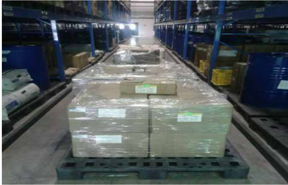
Figura 10. Pasillos del almacén con poco espacio para el manejo de materiales
