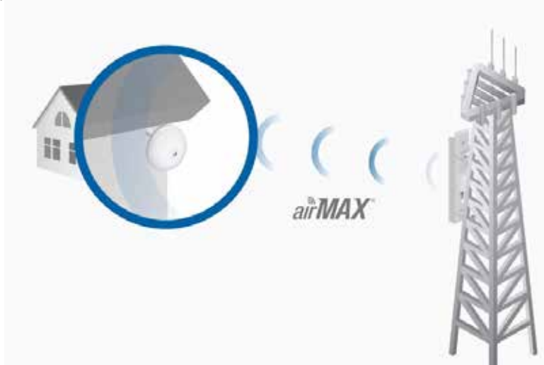
Figura 41: Ejemplo de funcionamiento del enlace entre AP y BS Fuente: airmax.ubnt.com (2017)
