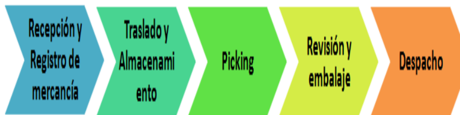
Figura 9. Diagrama de proceso de almacenaje de productos no refrigerados, refrigerados y congelados.
