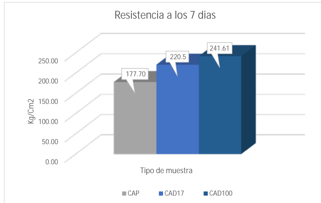
Figura 10: Resistencias a compresión de las muestras de concreto a los 7 días.
