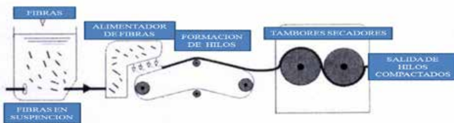
Figura 16. Procedimiento de compactación de fibras recicladas.
