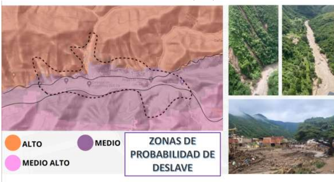
Figura 18: Diagrama de zonas de probabilidad de deslave en Las Tejerías, Estado Aragua. Fuente: R. Gomez (2023)
