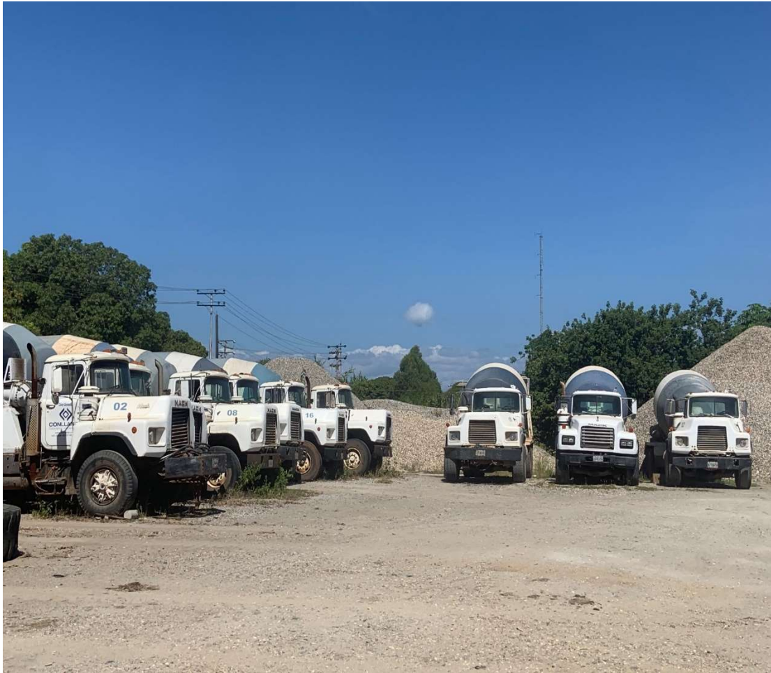
Gráfico 13: Camiones Mack mezcladores de hormigón
