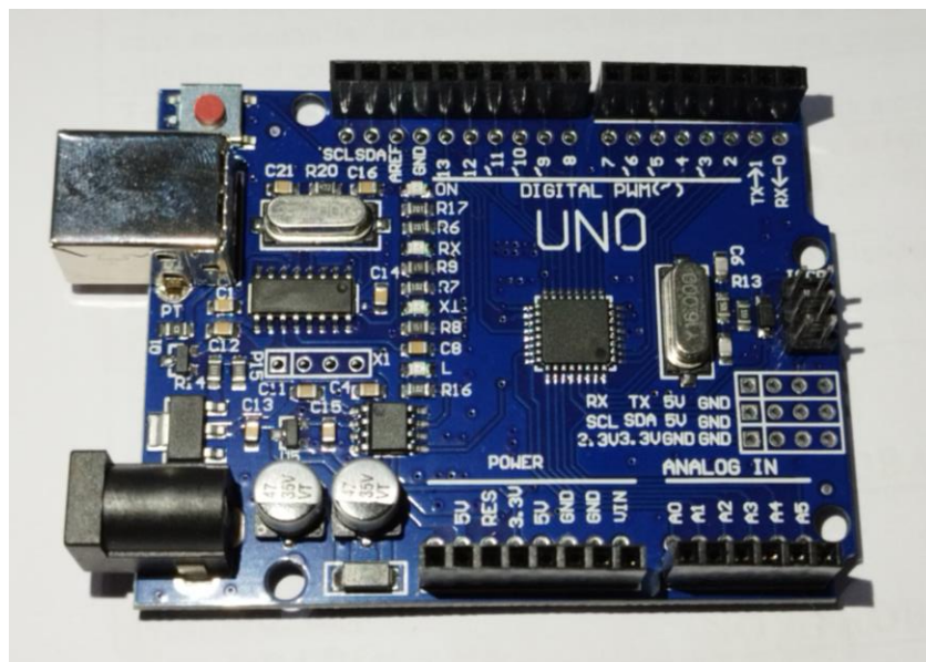
Figura 14. Placa de desarrollo Arduino UNO a utilizar en la tarjeta. Fuente: Reyes (2023).
