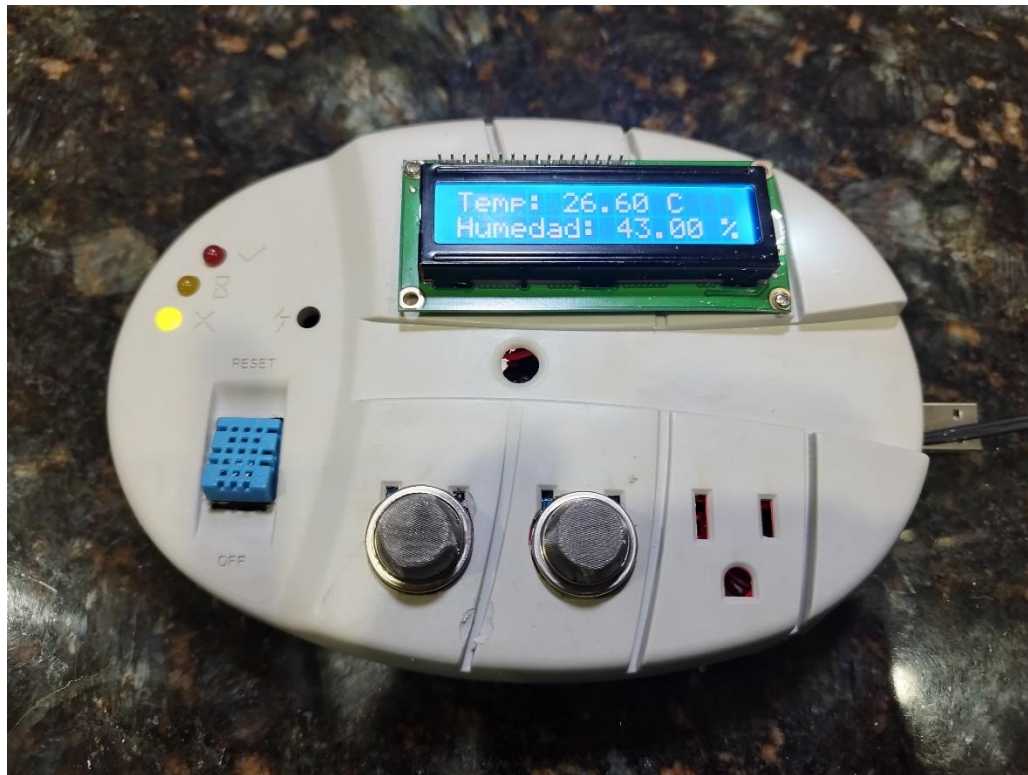
Figura 51. Pantalla de humedad y temperatura de la tarjeta de adquisición de datos. Fuente: Reyes (2023).
