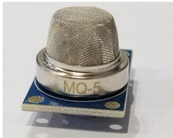
Figura 15. Sensor MQ-5 a utilizar en la tarjeta para medir GN.
