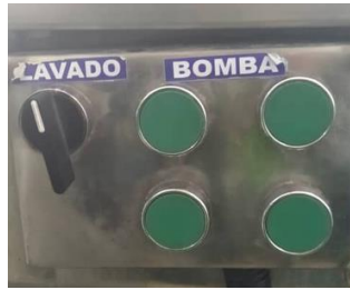
Figura 9: Botones para el control de la salida del agua en el sistema de llenado en conjunto al interruptor de lavado.
