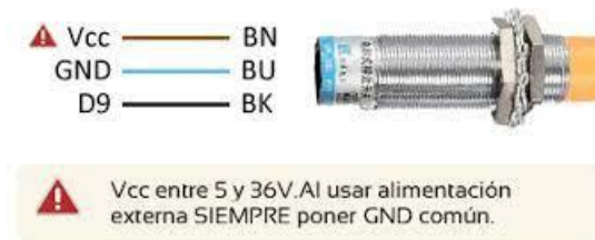
Figura 26: Cableado de los sensores capacitivos
