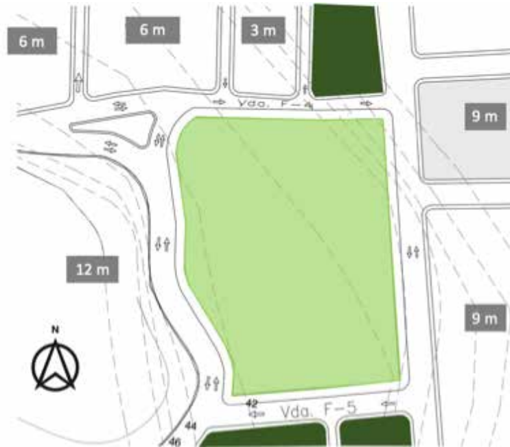
Altura de las edificaciones alrededor del Terreno de estudio.
