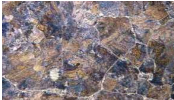
Figura 6: Presencia de Austenita. Fuente: http://throwate.blogspot.com/2014/02/los-aceros.html (2.017)
