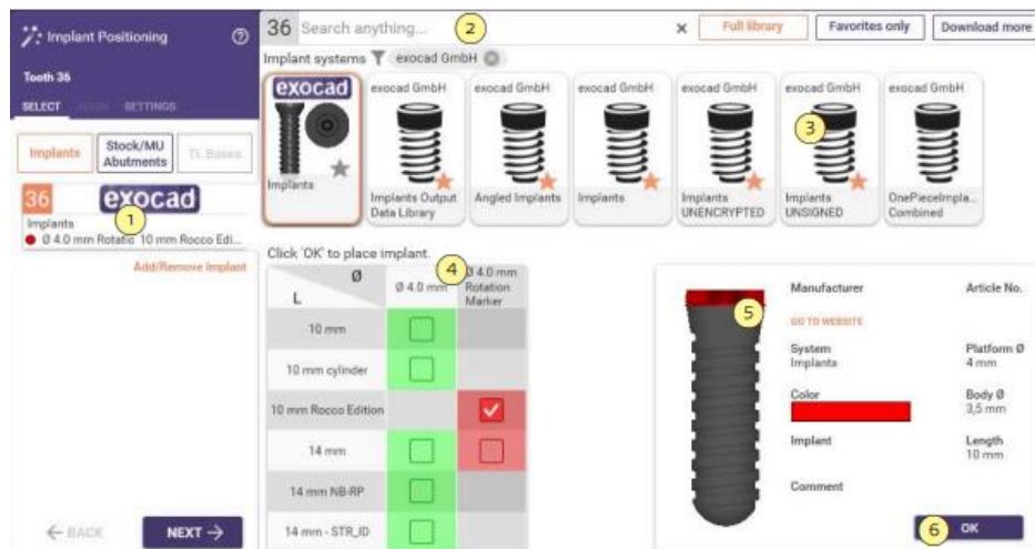
Imagen 10. Selección de la serie y tipo del implante en la biblioteca de fabricantes
