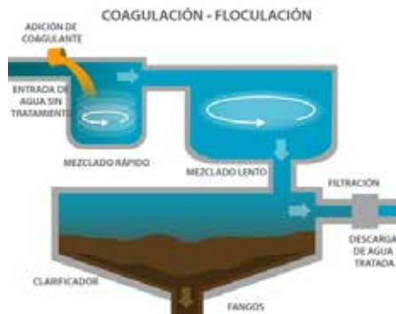
Figura 9. Esquema del funcionamiento de una Unidad de Precipitación Química. Academia Nacional de Ciencias (2007).
