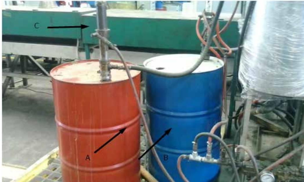
Anexo A: Figura 1. Tanque de almacenamiento de Polioli (A) e Isocianato (B) y Bomba neumática Graco (C) Fuente. Cristopher Chacón (2018).
