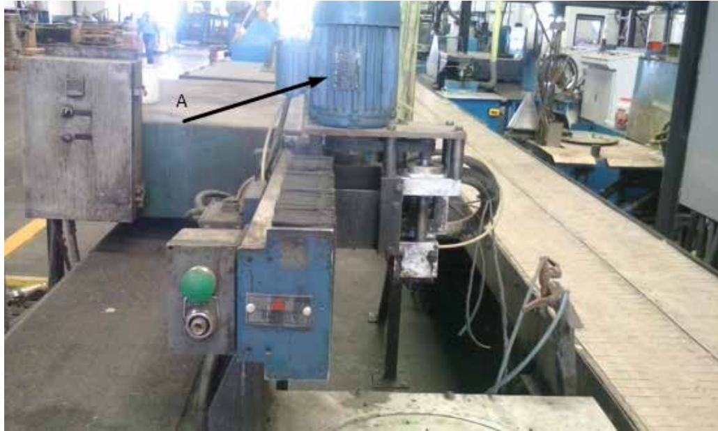
Anexo A: Figura 7. Servomotor del Cabezal (A) Fuente. Christopher Chacón (2018).
