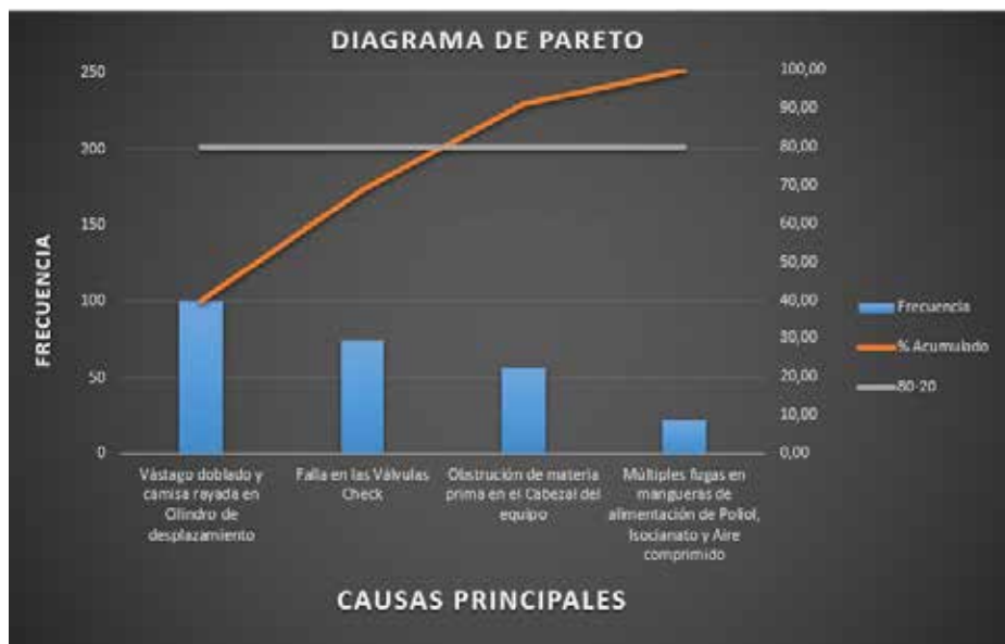
Figura 23. Diagrama de Pareto aplicado a la dosificadora radial MANN+HUMMEL Fuente. Christopher Chacón (2018).
