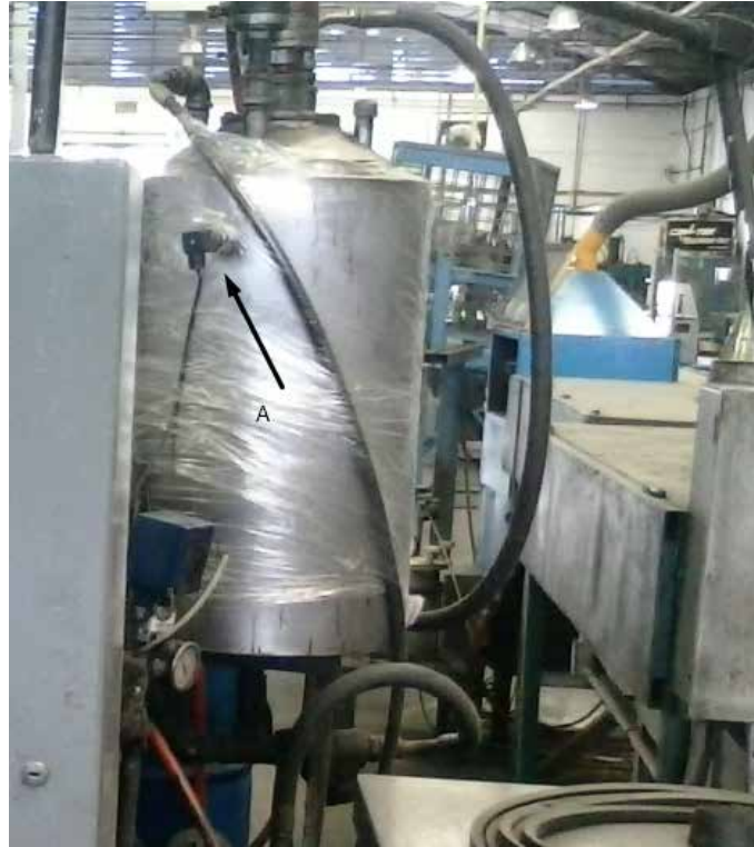
Anexo A: Figura 9. Sensor de nivel en tanque de mezcla de Polioli e Isocianato (A) Fuente. Cristopher Chacón (2018).
