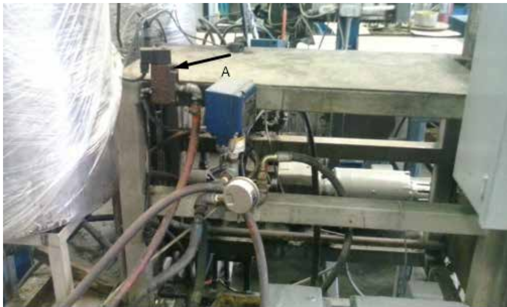
Anexo A: Figura 6. Válvula neumática 5/2 de la línea de alimentación de Poliolo e Isocianato (A)
