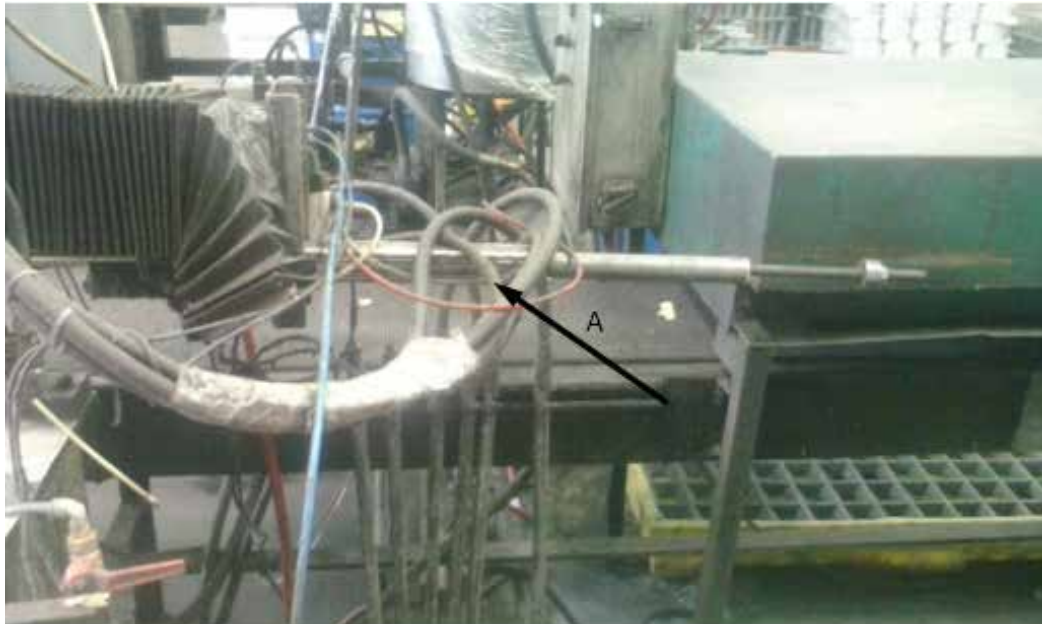
Anexo A: Figura 8. Actuador principal doble efecto (A) Fuente. Christopher Chacón (2018).
