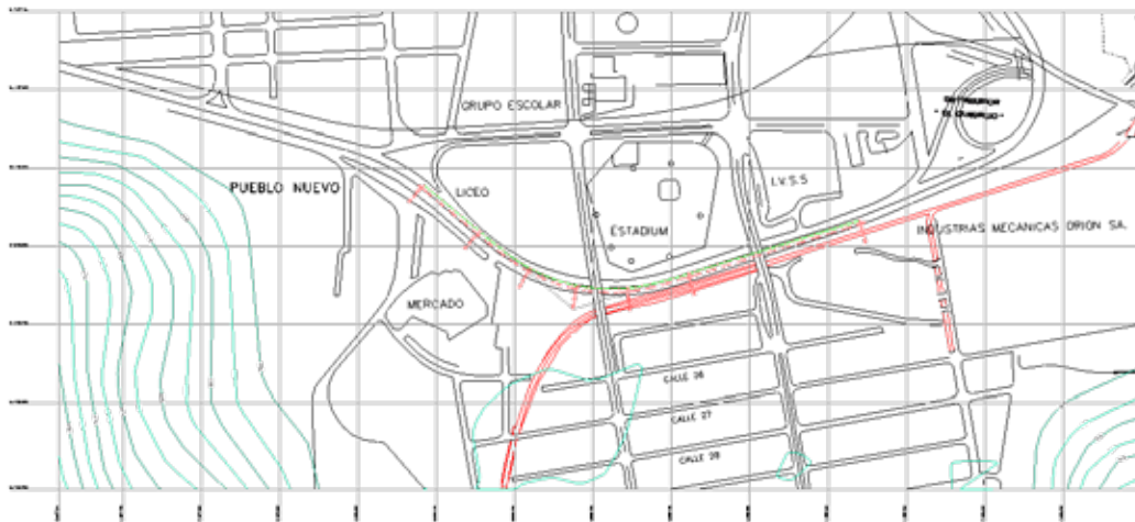
Figura 20: Levantamiento de clotoide con topograf6a en zona de estudio con AutoCAD Civil 3d
