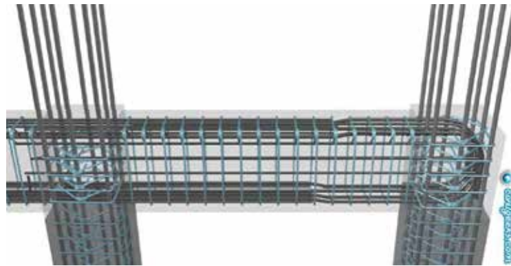
Figura 20: Viga de concreto armado. Fuente: http://www.arqhys.com (2017)
