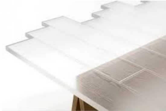
Fig 28 . Ejemplo de Madera Transparente. Fuente: Google imágenes.
