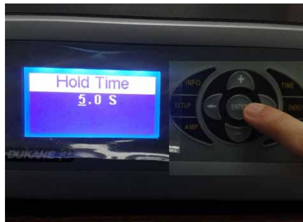
Figura 61. Establecer el tiempo de sostenido en equipo de soldadura Dukane
