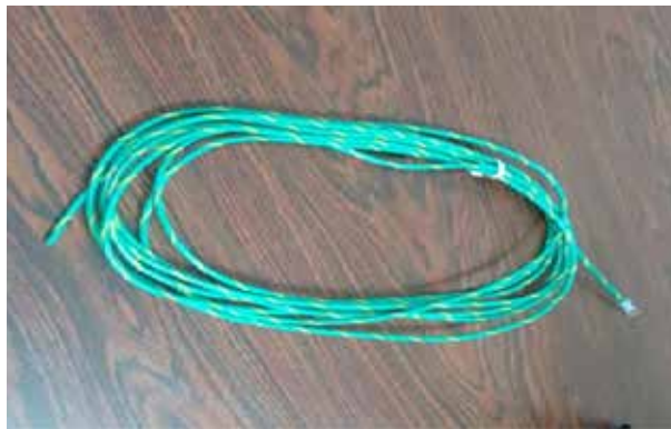
Figura 39. Cable de tierra
