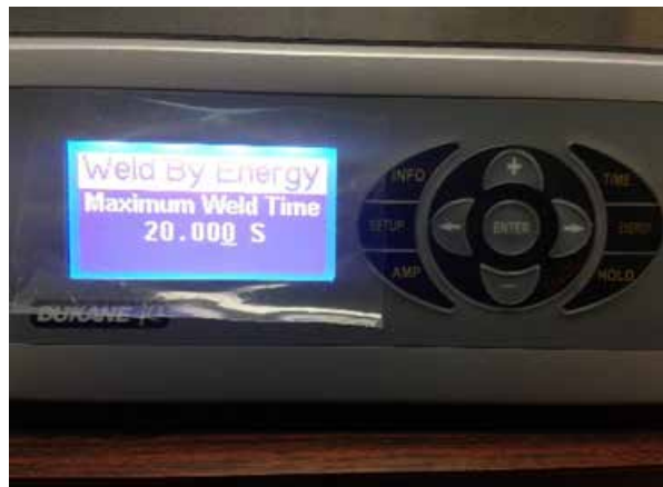
Figura 55. Tiempo máximo de soldadura en equipo de soldadura Dukane
