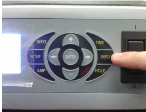
Figura 50. Botón de energía en equipo de soldadura Dukane
