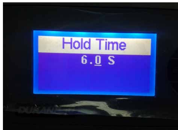
Figura 59. Pantalla de tiempo de sostenido en equipo de soldadura Dukane
