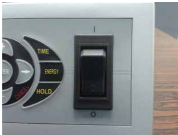
Figura 48. Botón de encendido y apagado en equipo de soldadura Dukane
