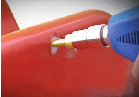
Figura 24. Soldadura por inyección
