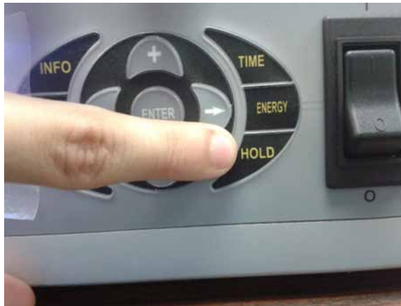
Figura 58. Botón de sostenido en equipo de soldadura Dukane
