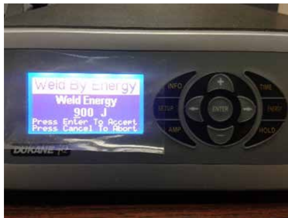
Figura 51. Pantalla de parámetros en equipo de soldadura Dukane
