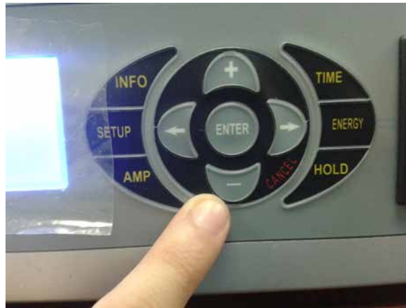
Figura 60. Modificar el tiempo de sostenido en equipo de soldadura Dukane
