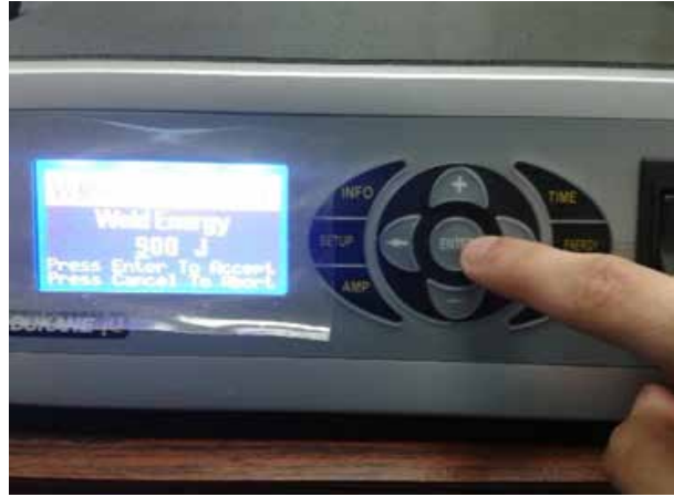
Figura 54. Valor de la energía en equipo de soldadura Dukane
