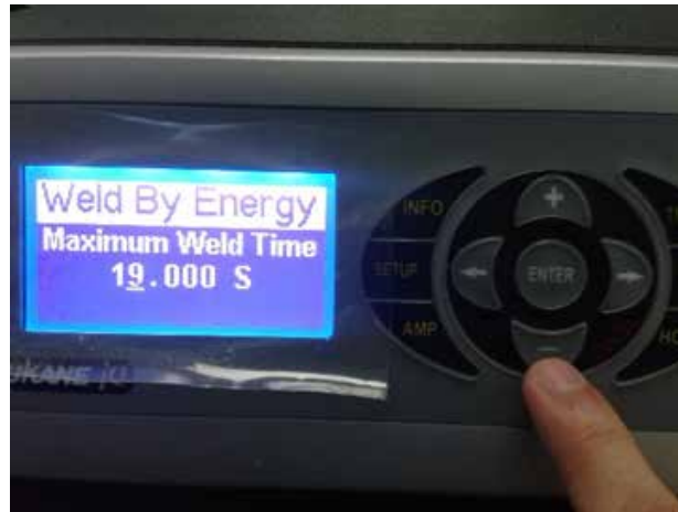
Figura 56. Modificar el valor del tiempo en equipo de soldadura Dukane
