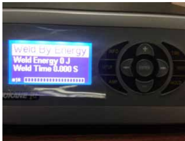
Figura 49. Menú de inicio en equipo de soldadura Dukane
