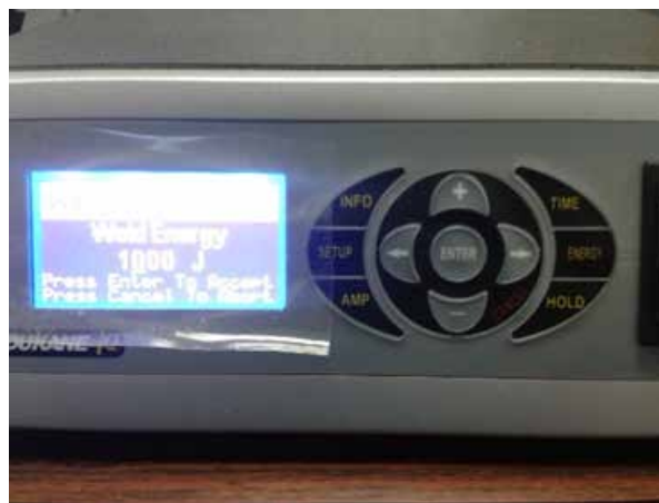
Figura 53. Parámetro de energía en equipo de soldadura Dukane
