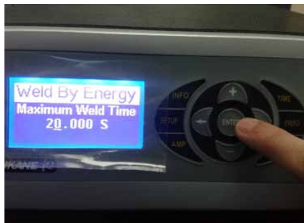
Figura 57. Establecer el tiempo en equipo de soldadura Dukane
