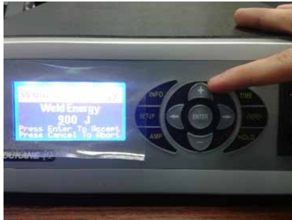
Figura 52. Valor de energía en equipo de soldadura Dukane
