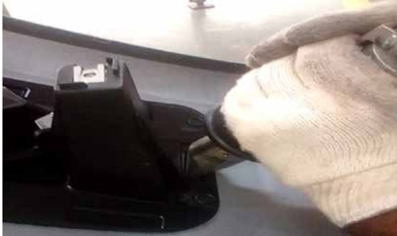
Figura 71. Contacto con el sonotrodo y pieza a soldar
