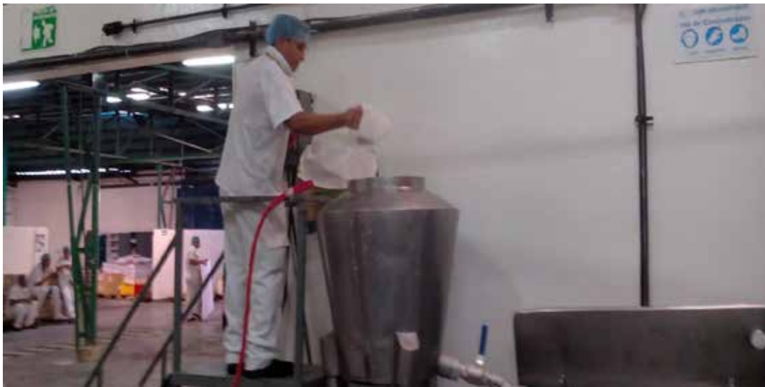
Figura 4: Proceso de preparación del jarabe invertido (Marmita de Cocción). Fuente: Procesadora Naturalyst S.A. (2020).
