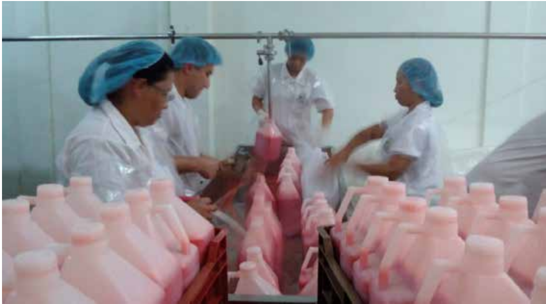
Figura 6: Proceso de llenado y tapado del producto de forma manual. Fuente: Procesadora Naturalyst S.A. (2020).
