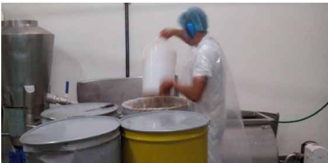
Figura 5: Proceso de adición en la mezcladora del estabilizante de forma manual. Fuente: Procesadora Naturalyst S.A. (2020).
