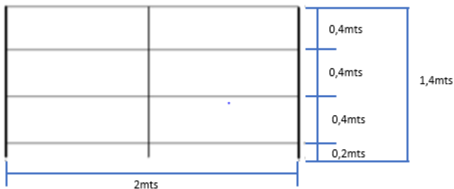
Figura 36: Dimensiones de los racks para almacén PT
