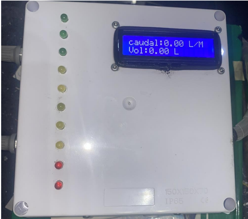
Figura 32. Foto del 0% del nivel – caudal 0- volumen 0 Fuente: Ferrer y Rodríguez (2022)
