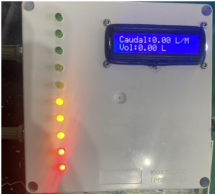
Figura 33. Foto del 50% del nivel – caudal 0- volumen 0 Fuente: Ferrer y Rodríguez (2022)
