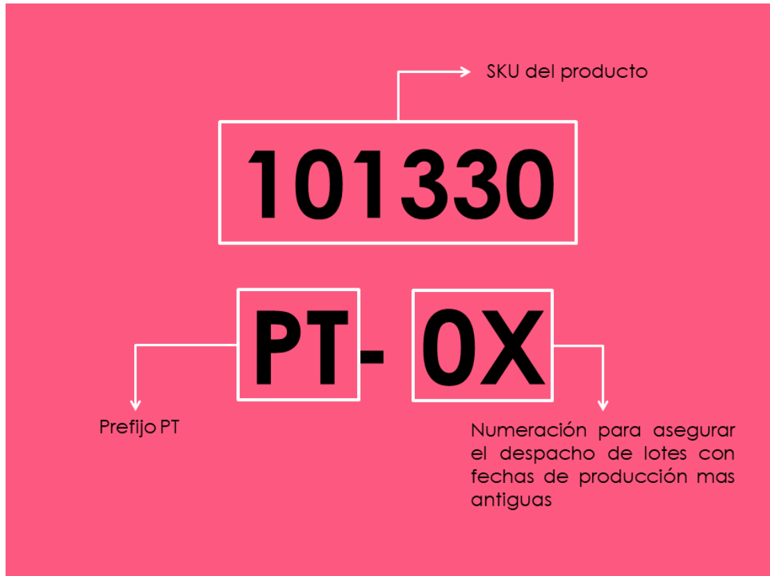
Figura 27: Ejemplo de hablador con código para la propuesta KANBAN Autor: Rincón, A. (2021)
