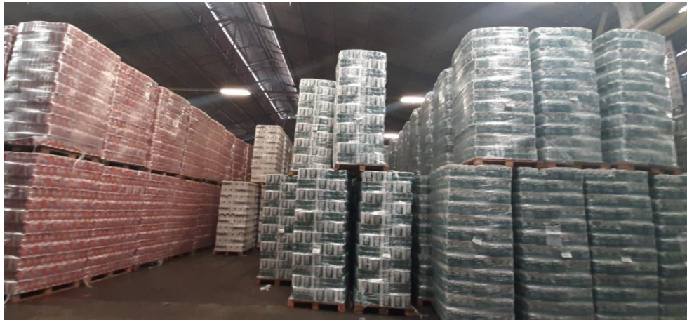
Figura 17: Producto terminado paletizado almacenado sin separación de seguridad Autor: Rincón, A. (2021).
