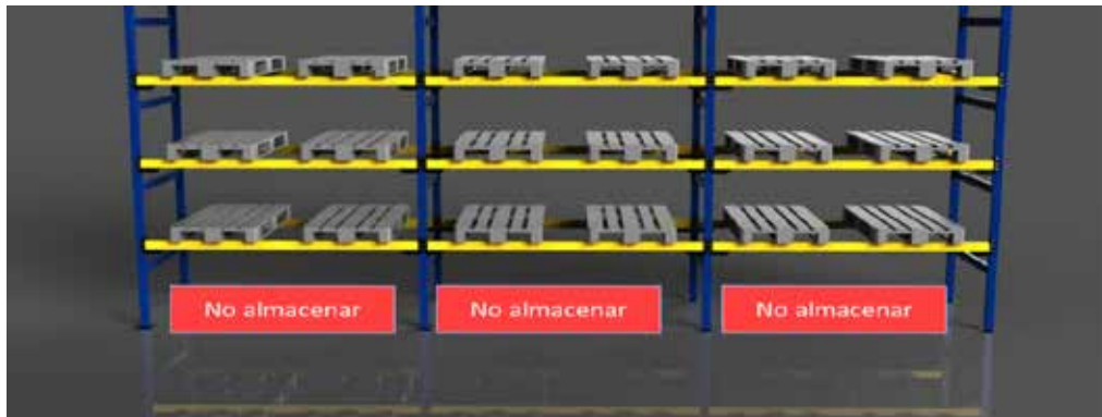
Figura19 zona de no almacenar en los racks
