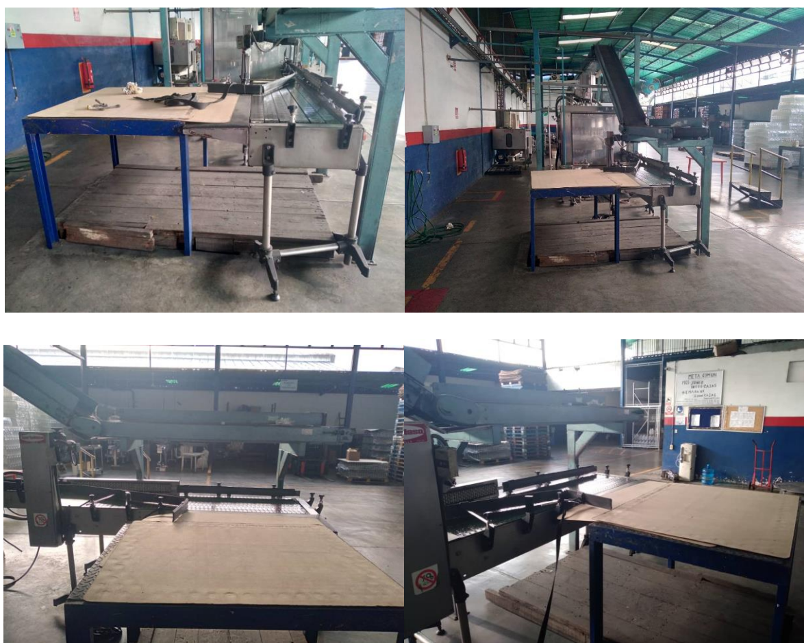
Figura 5. Inicio de la línea de producción y mesa empleada durante el proceso de alimentación.
