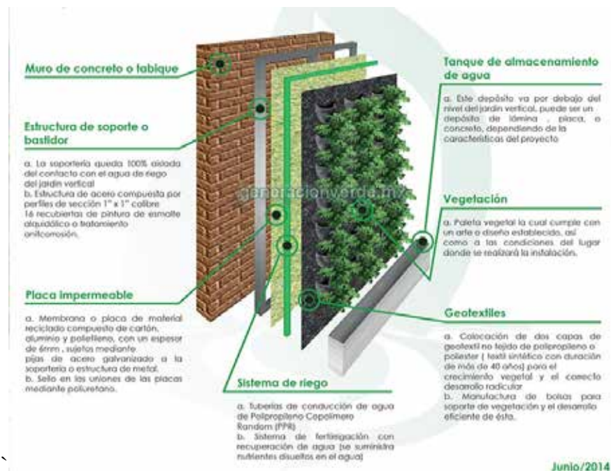
Figura 33: Proceso constructivo de una pared verde.
