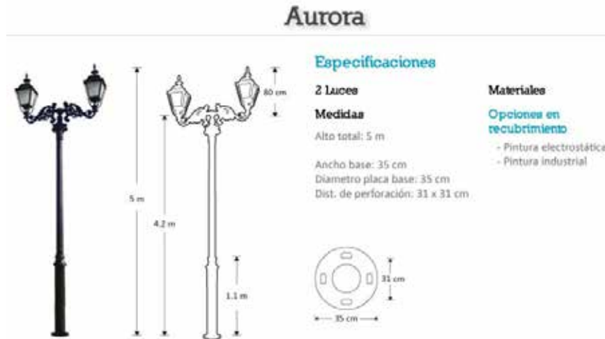
Figura 30: Poste colonial tipo Aurora.
