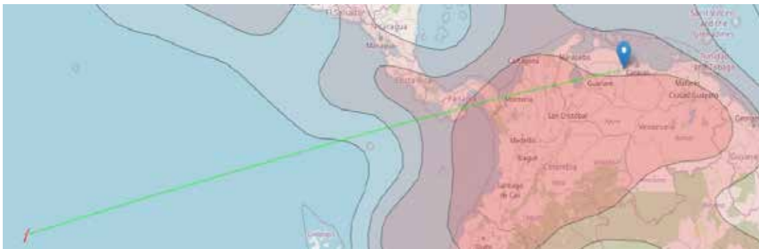
Figura 22. Huella Banda Ku de Satmex 6 (Eutelsat 113 Oeste A)
