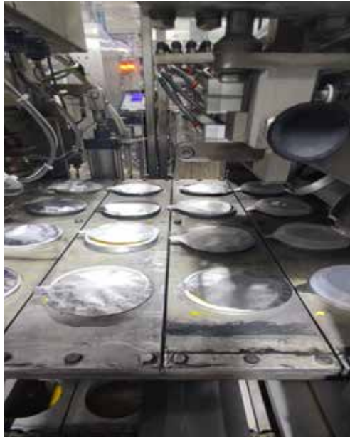
Figura 2. Máquina Trepko 1 en el proceso de sellado Fuente: Quintana, A. y Díaz, M. (2021)
