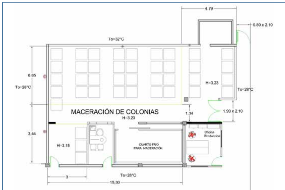
Figura 12 Plano del área de maceración con medidas.
