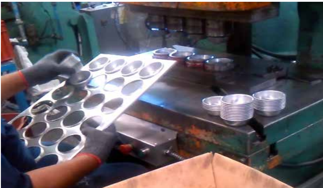
Figura 11. Unión del vaso con la lámina de aluminio para ponqués Fuente: Empresa Alum Ware C. A (2017).
