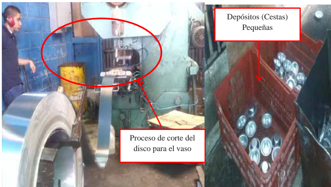
Figura 7. Proceso de corte del disco para el vaso.
