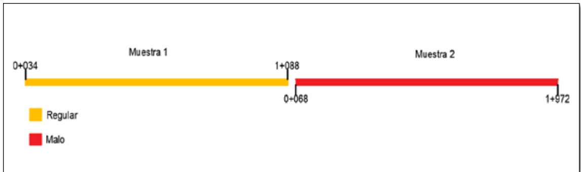
Figura 6. Estado de la vía Este-Oeste
