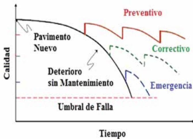
Figura 2. Esquema de ciclo de vida de un pavimento y los momentos de mantenimiento.
