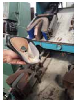
Figura 11 ensamble de talón Inversiones Via K, C.A
