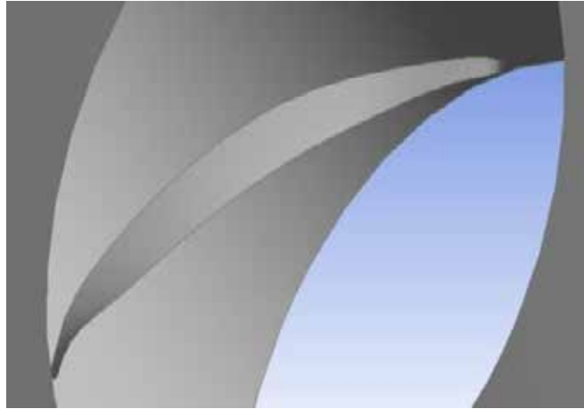
Figura 16. Detalle del dominio fluidizado en la zona de los alabes del rotor.
