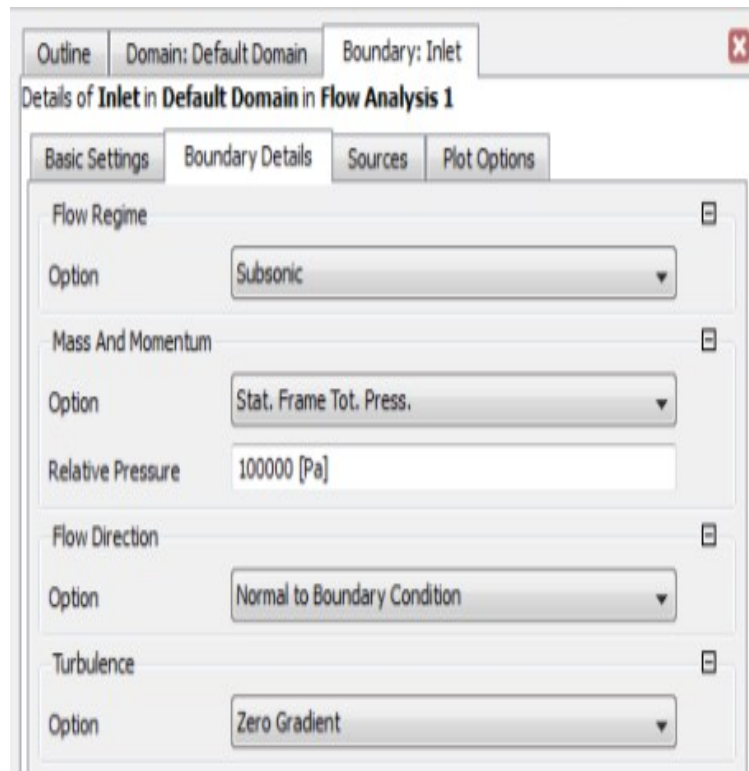
Figura 34. Detalles de la configuración de la entrada (inlet). Fuente: Ansys Workbench 18.1 (2017)
