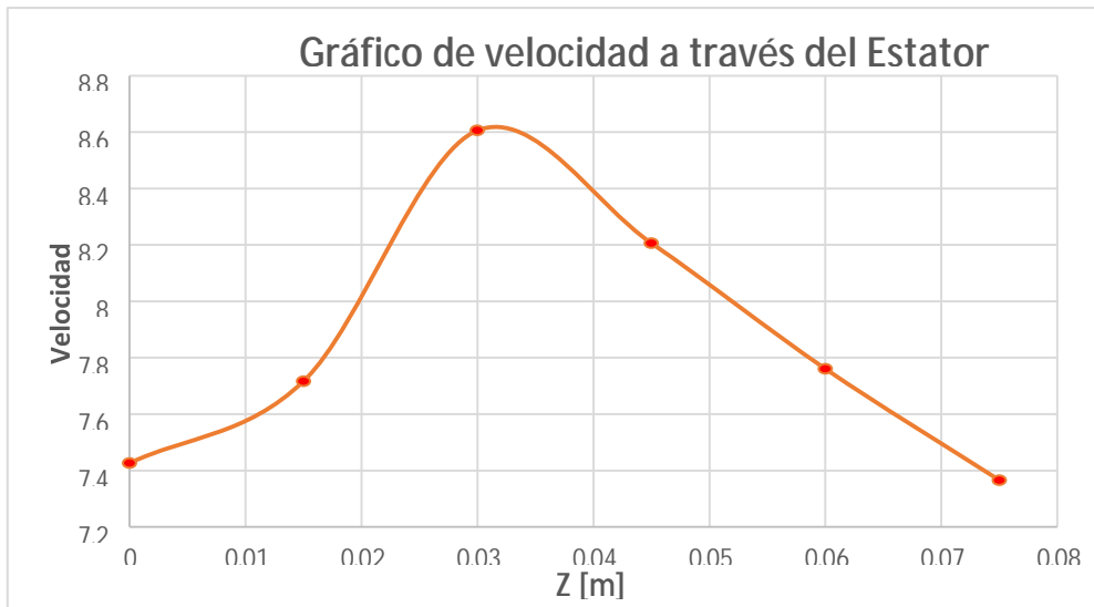
Gráfica 9. Gráfica de variación de velocidad del flujo a través estator con rotor girando a 850 rpm.
