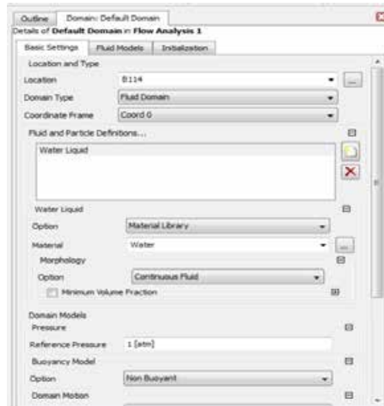
Figura 30. Configuraciones básicas del dominio fluidizado Fuente: Ansys Workbench 18.1 (2017)
