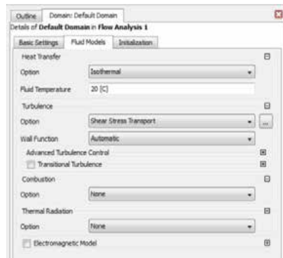
Figura 31. Configuración del modelo de fluido y modelo de turbulencia. Fuente: Ansys Workbench 18.1 (2017)
