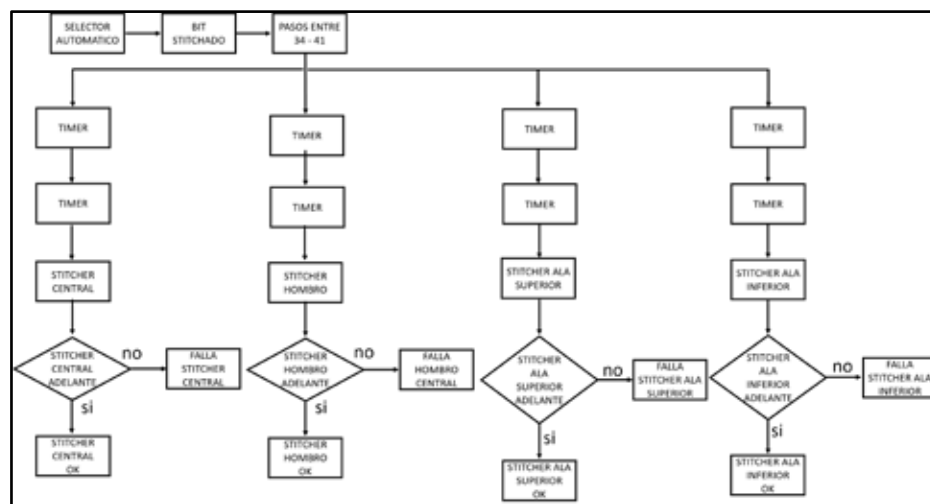
Figura 29: Diagrama de bloques de las condiciones de los stitchers. Fuente: Mahomud, Samir. (2019).
