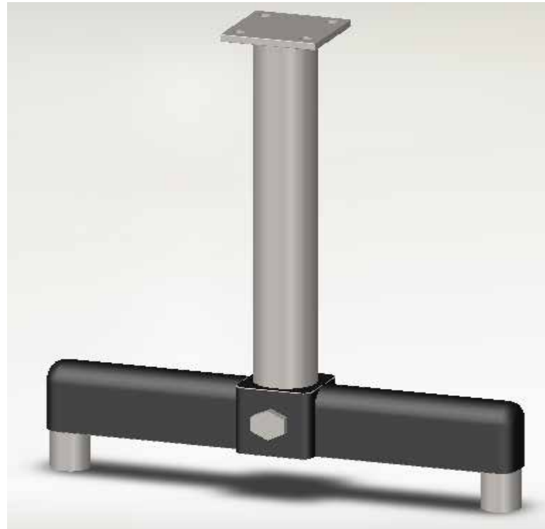
Figura 55: Diseño de la base que soportará al transportador. Fuente: Lugo (2017).
