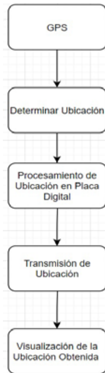
Figura 17. Estructura de funcionamiento GPS.
