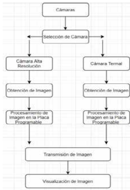
Figura 16. Estructura de Funcionamiento de Cámaras.
