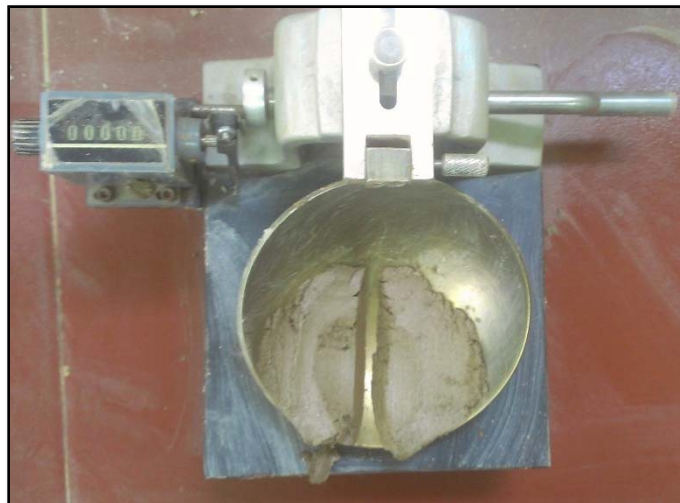
Copa de Casagrande para prueba de límite líquido
