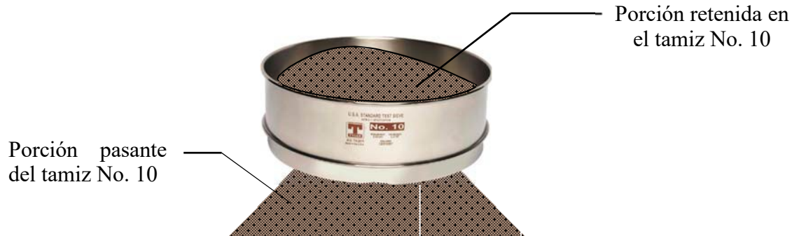
Fig. 18. La norma ASTM separa el análisis mecánico en dos partes
