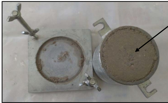
Sección inferior del cilindro Proctor 4 in, desprendida de la placa base
