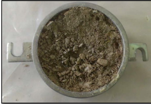
Collarín del cilindro Proctor (4 in) con material compactado
