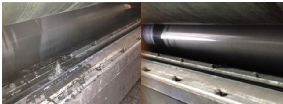
Figura 5: Limpieza del cuerpo impresor Fuente: Conversión (2015)
