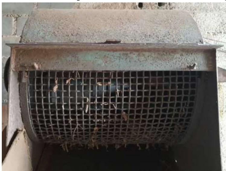
Figura N° 07 Malla Metálica por donde Sale la Picadura de la Hoja de Tabaco
