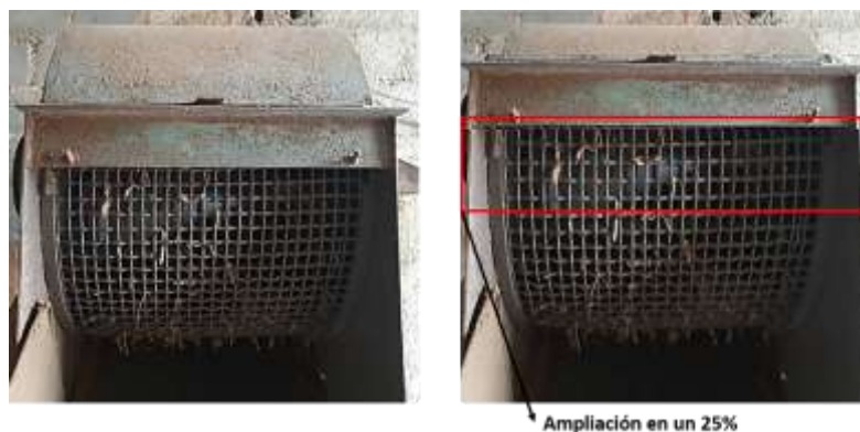
Figura N°29 Ampliación de la Malla Metálica
