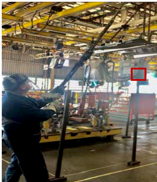
Figura 28: Simulación traslado sub-ensamble con equipo Form & Pierce. Fuente: Peláez O (2018).
