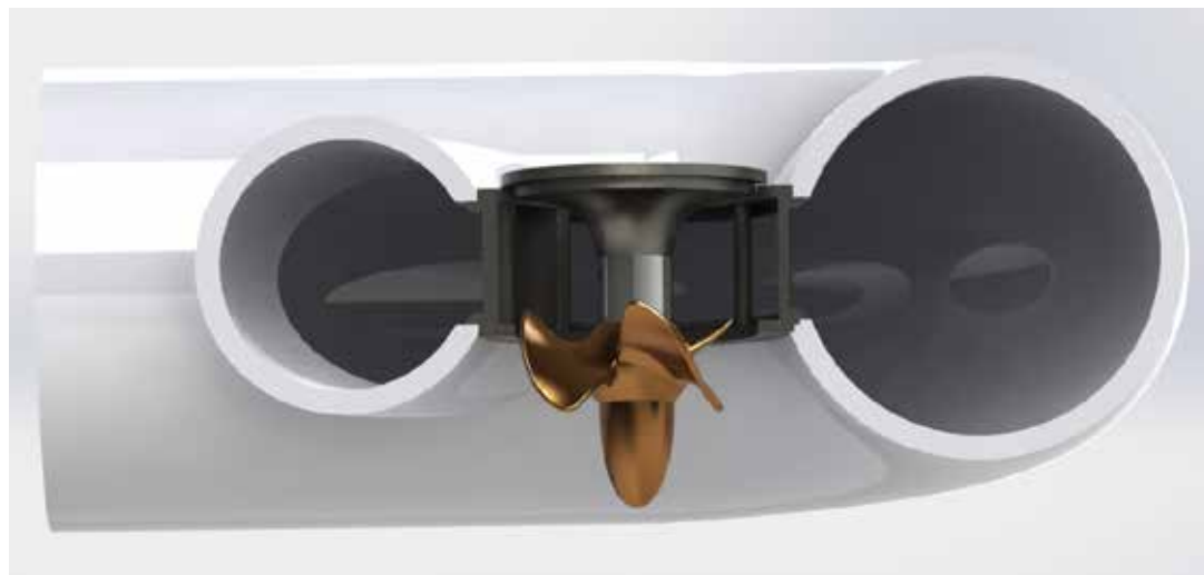
Figura 5. Turbina Kaplan vista del corte de perfil Fuente: Mier y Terán (2019)
