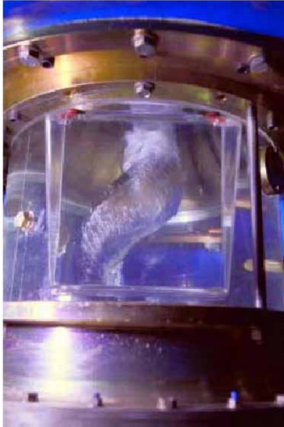
Figura 20. Cavitación tipo antorcha en turbinas hidráulicas
