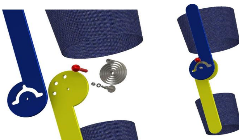
Figura 15 Resorte para restauración de movimiento
