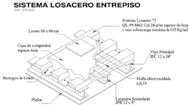
Figura 44. Detalle de la losacero Fuente: https://sites.google.com/site/tecnolchristianescobar/losas/losa-aligerada/losacero .
