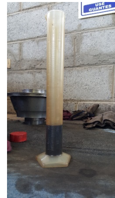
Figura 4. Ligante asfáltico extraído del agregado
