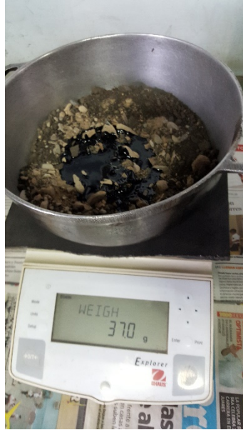
Figura 7. Agregados antes de mezclarse Con el Cemento Asfáltico.
