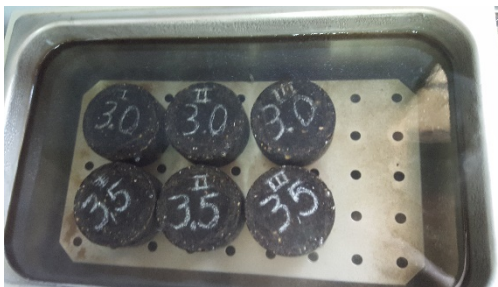
Figura 13. Briquetas sumergidas en agua.
