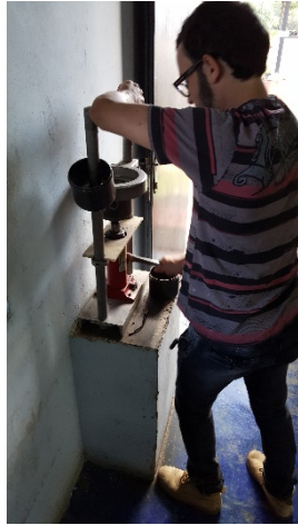
Figura 10. Extracción de la briquetta del molde.
