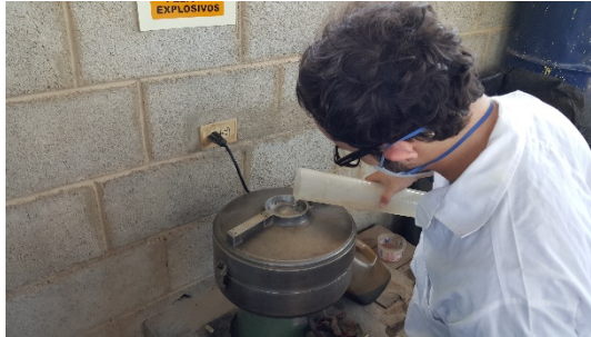
Figura 2. Colocación de xilol en la máquina centrifugadora.
