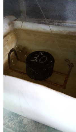
Figura 12. Pesada de briquetta sumergida.
