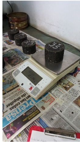
Figura 11. Pesada de briquetta seca.
