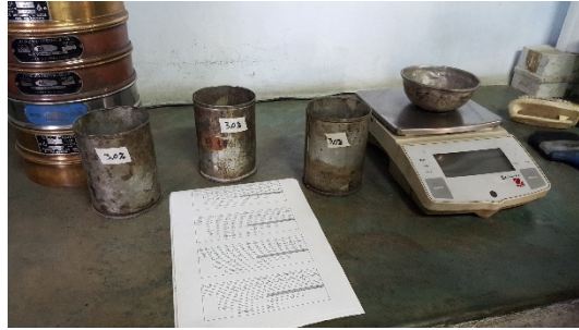
Figura 5. Pesada de agregados para la combinación con 3% de C.A
