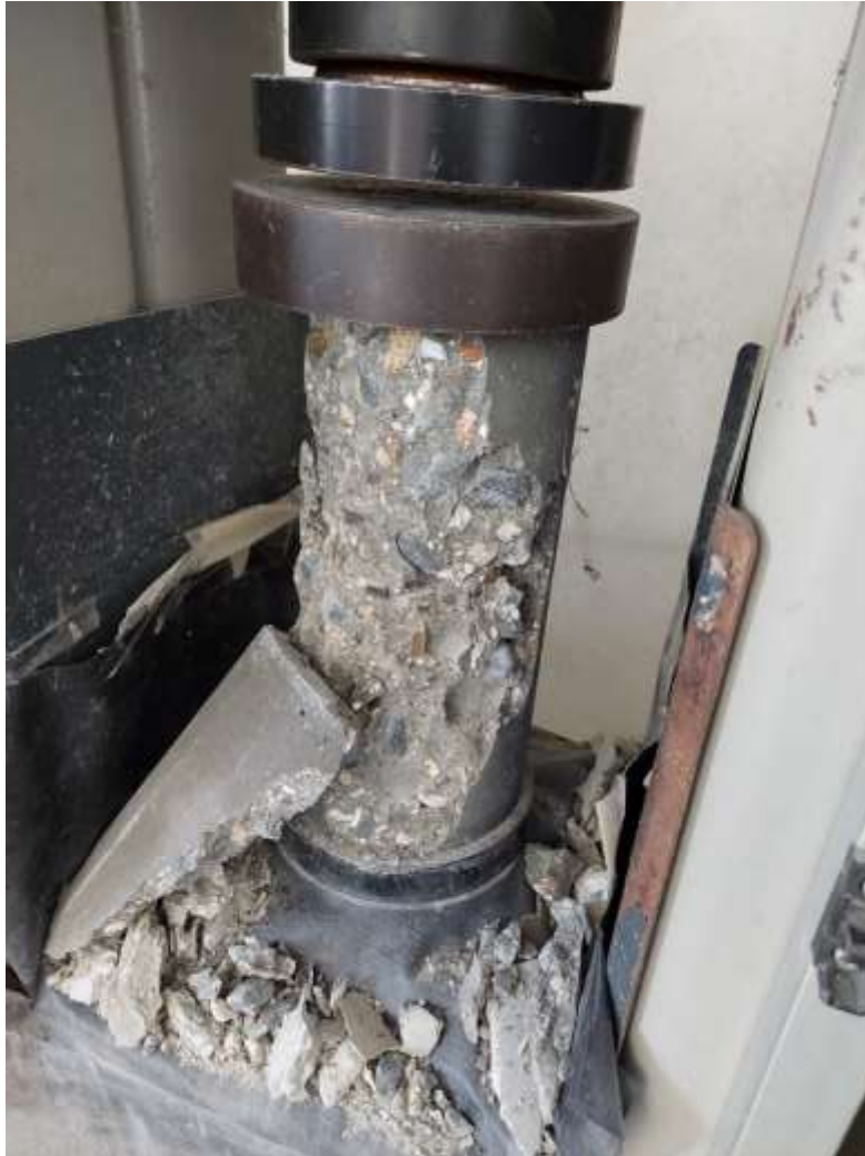
Figura 32: Representación de fractura de probeta cilíndrica.
