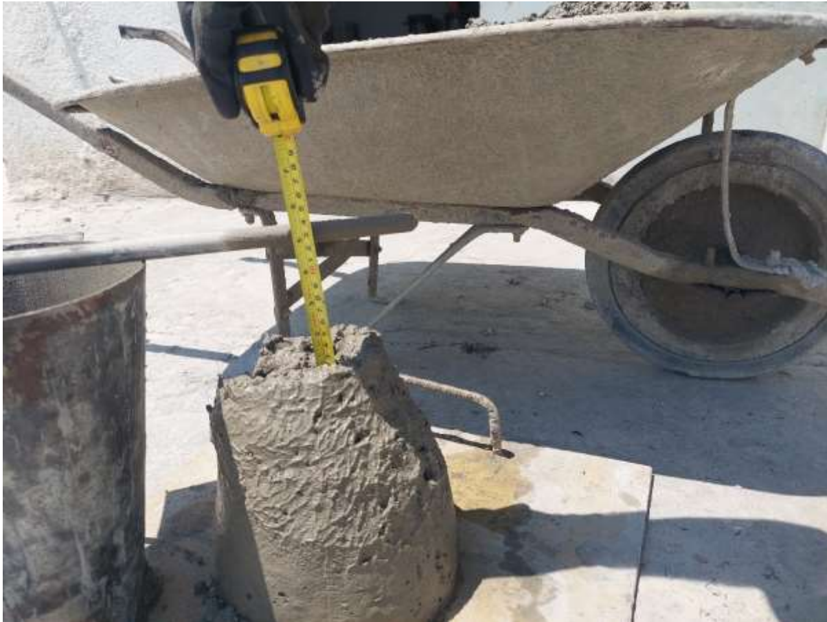
Figura 23: Prueba de asentamiento mediante el Cono de Abrams.
