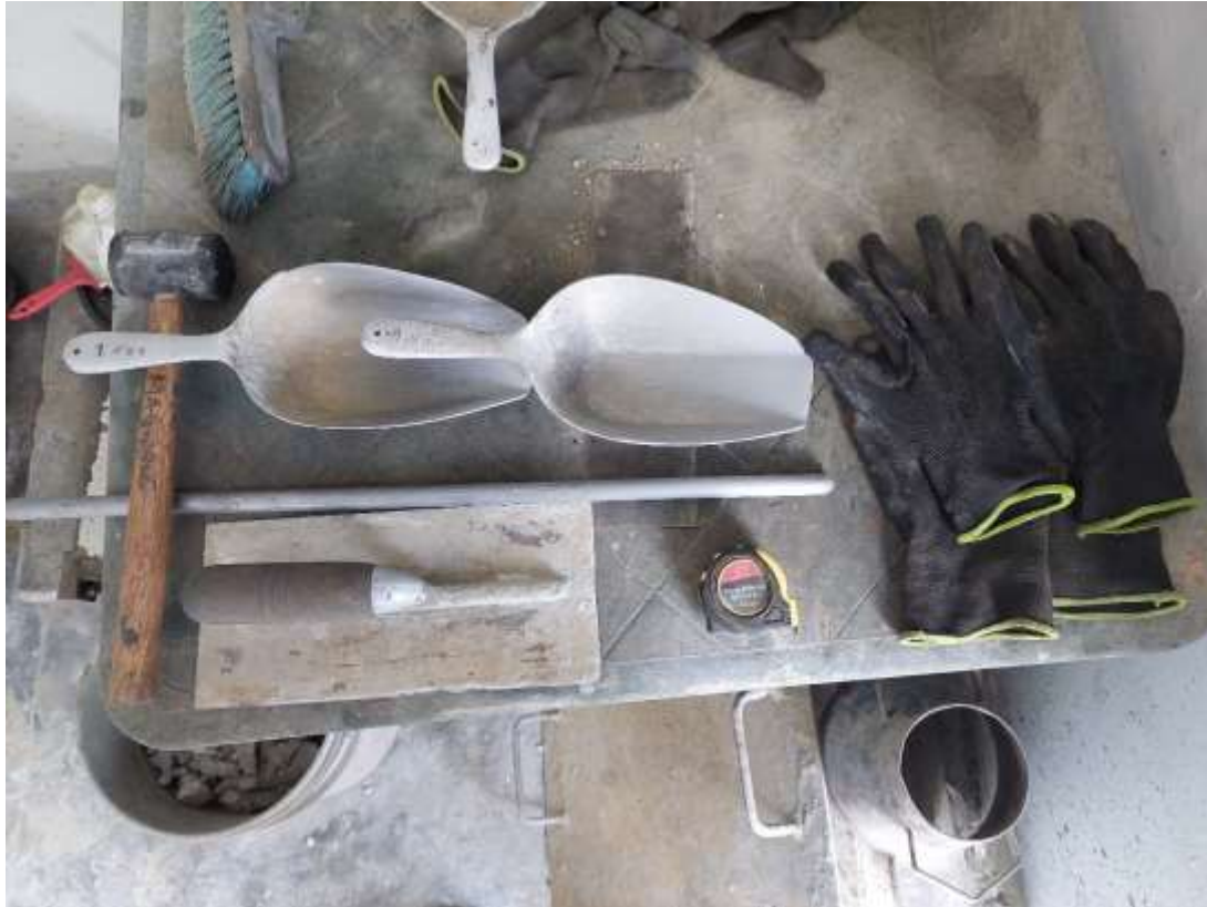
Figura 24: Herramientas y equipo utilizado para fabricar probetas cilíndricas.
