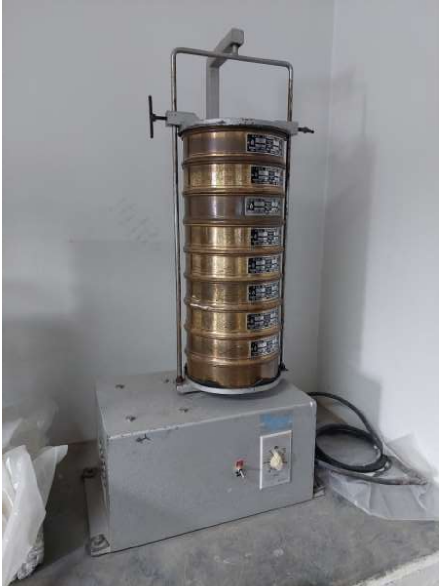
Figura 7: Tamizado de agregado fino.
