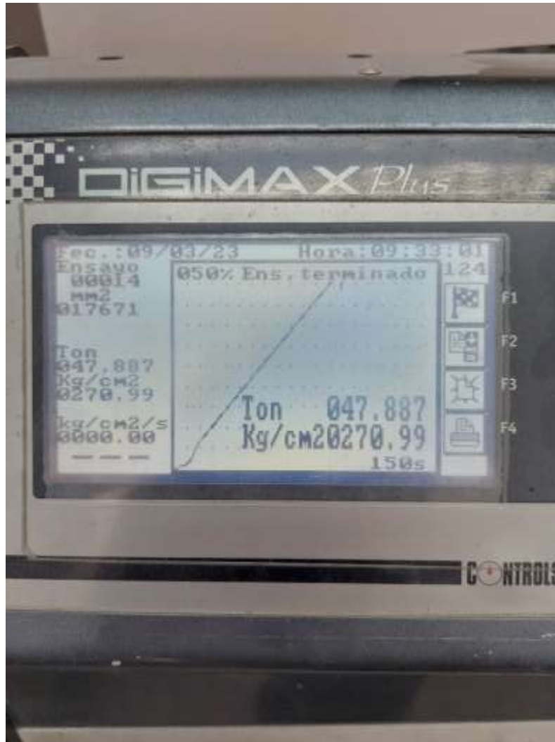
Figura 31: Ensayo a compresión culminado.
