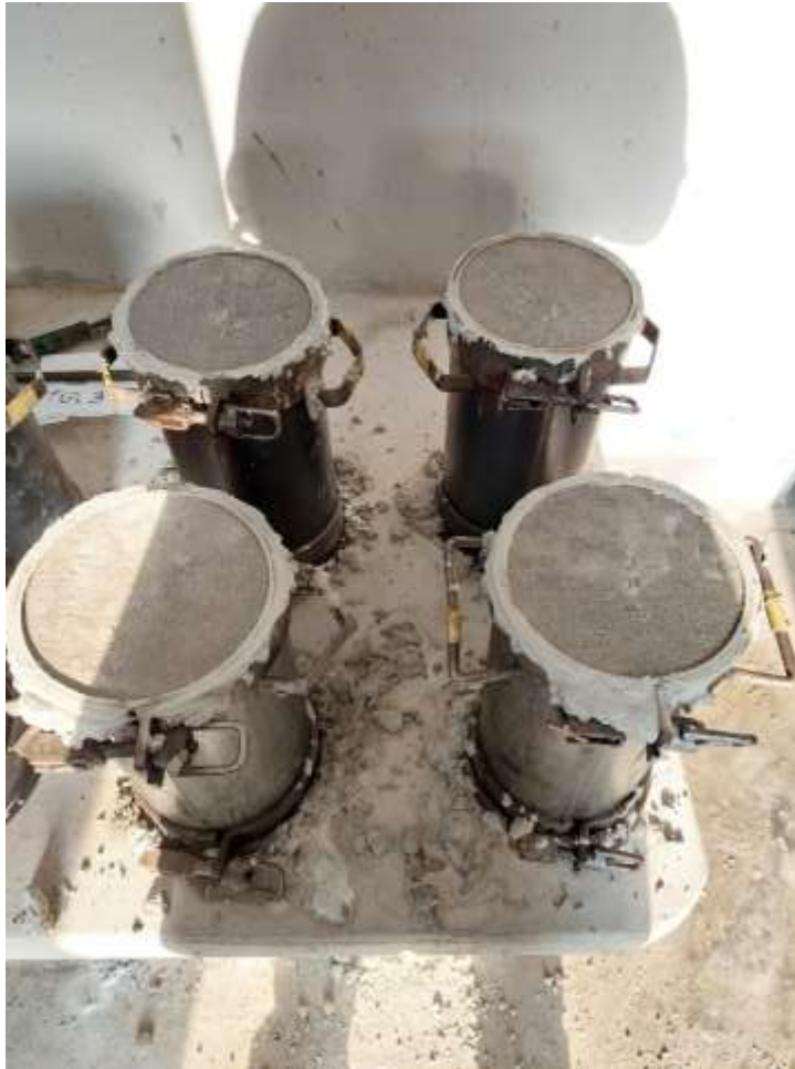
Figura 26: Muestra de concreto a las 24 horas de fraguado.
