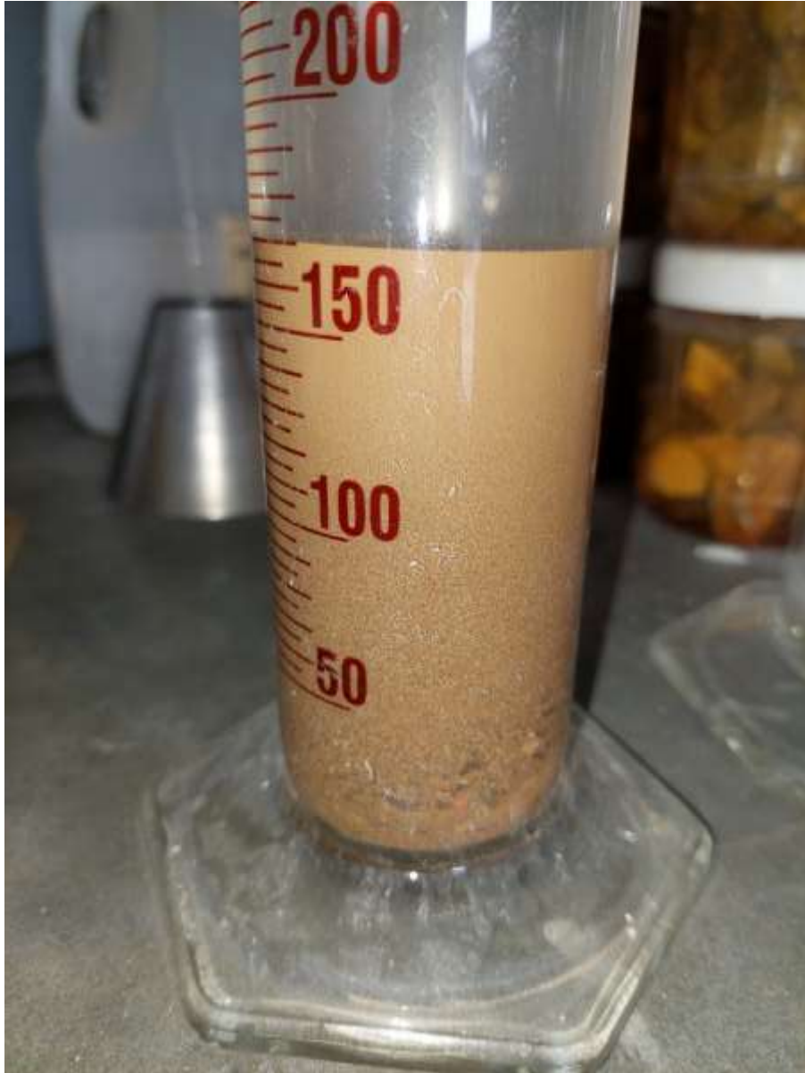
Figura 10: Prueba por decantación de arcillas crudas.
