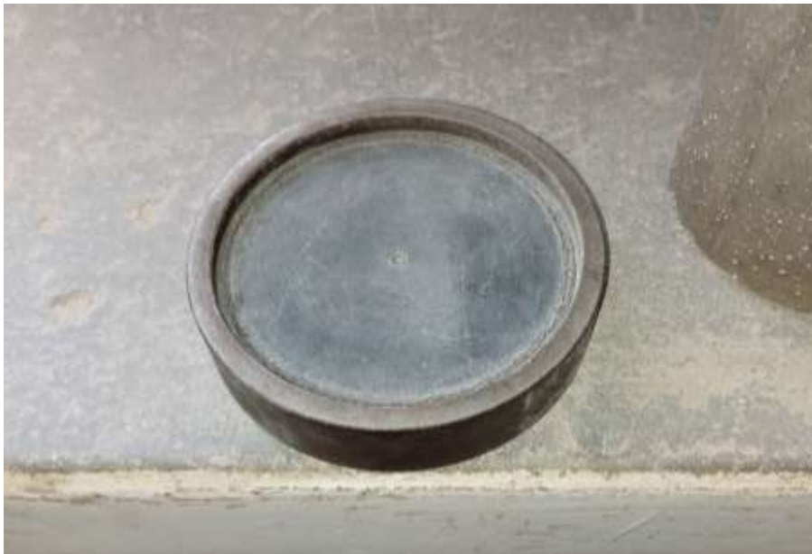
Figura 28: Retenedor de acero y neopreno para ensayos a compresión de probetas cilíndricas.
