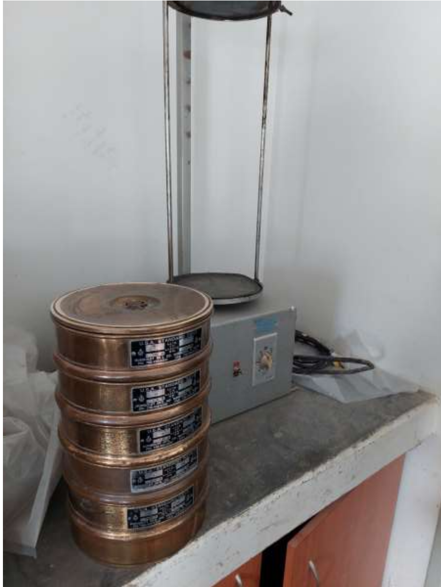
Figura 9: Tamizado de agregado grueso.
