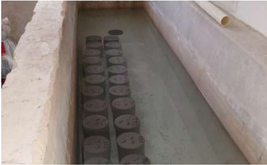
Figura 27: Probetas cilíndricas en piscinas de curado.
