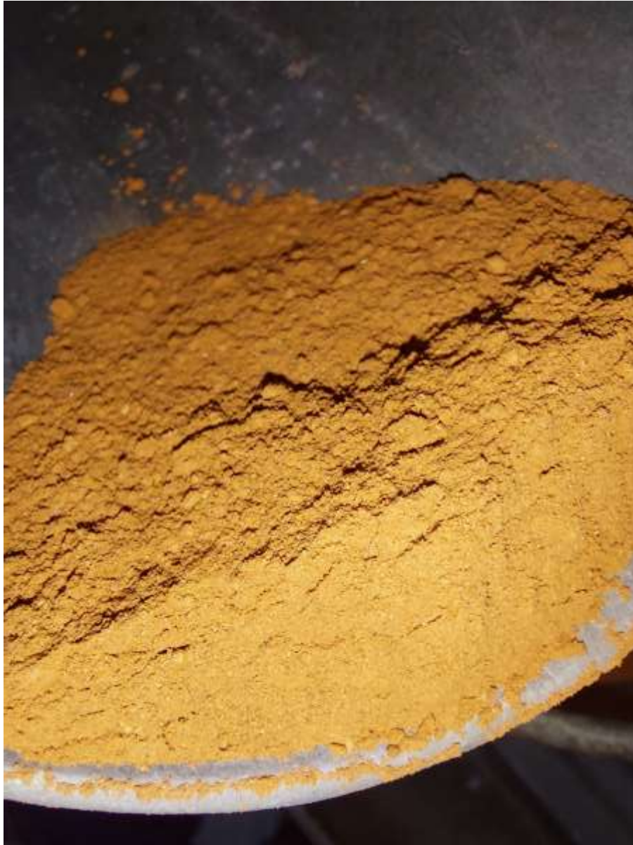
Figura 11: Muestra de arcillas calcinadas.
